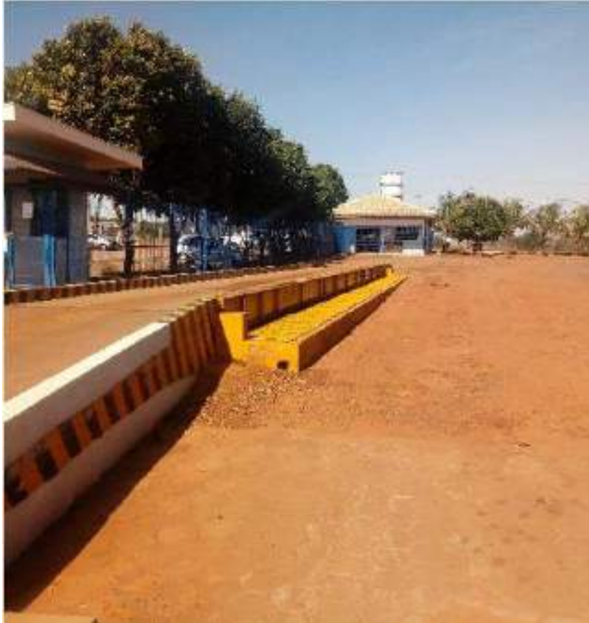
Figura nº 20 - Balança com Capacidade para 80Toneladas. FONTE: Acervo das unidades industriais da empresa
