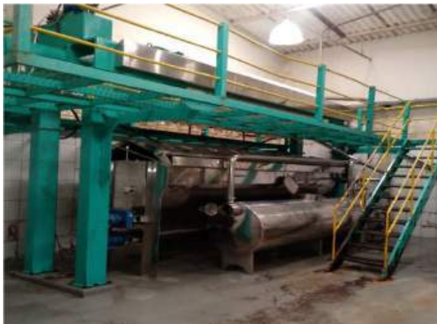
Figura nº 27 - Filtro Prensa com 35 placas
