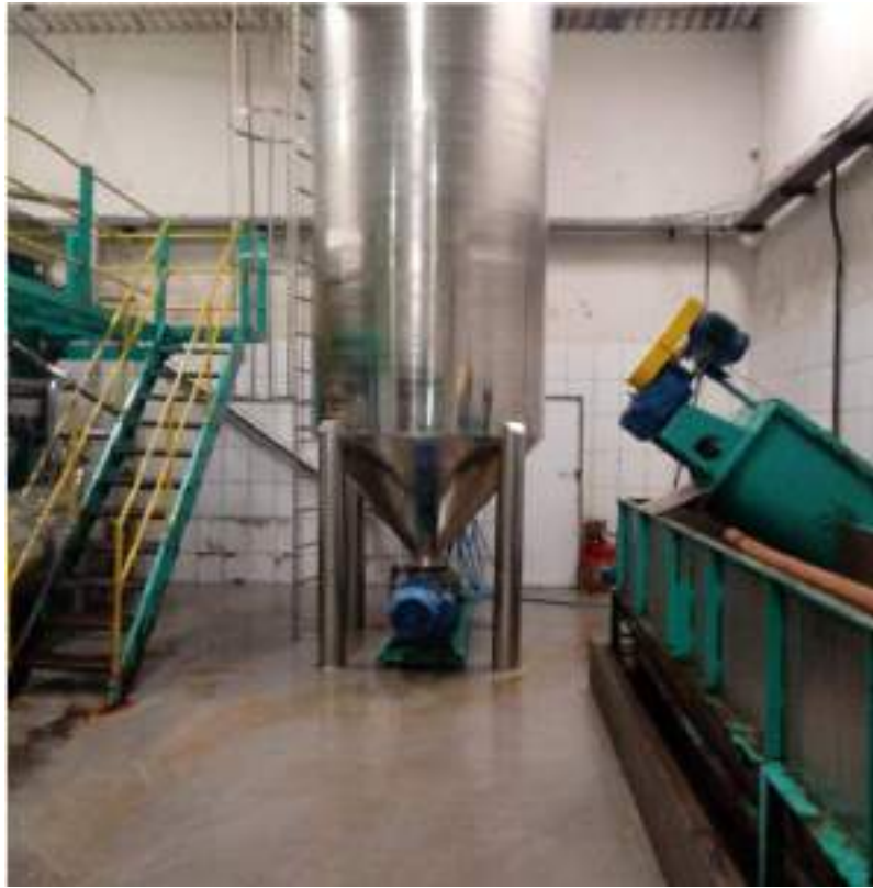
Figura nº 26 - Tanque pulmão em inox FONTE: Acervo das unidades industriais da empresa
