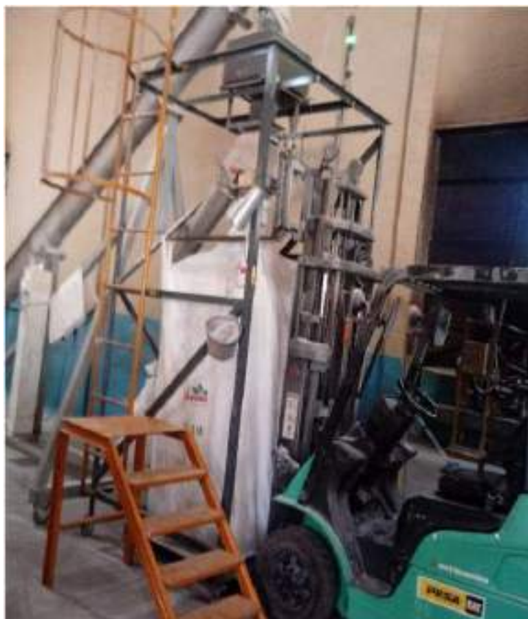
Figura nº 32 - Balança varão com Detector de Metal FONTE: Acervo das unidades industriais da empresa
