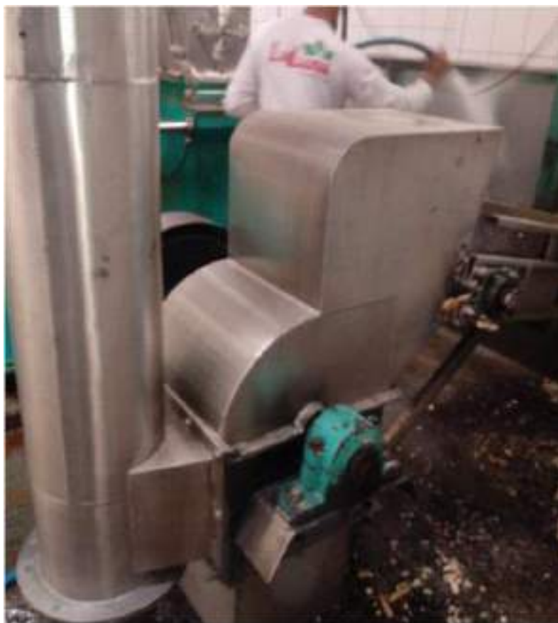
Figura nº 24 - Picador de Raiz motor 20 CV
