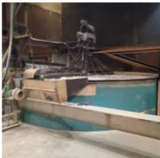
Figura nº 29 - Forno de Biju e Conjunto Forno Pré-aquecedor FONTE: Acervo das unidades industriais da empresa
